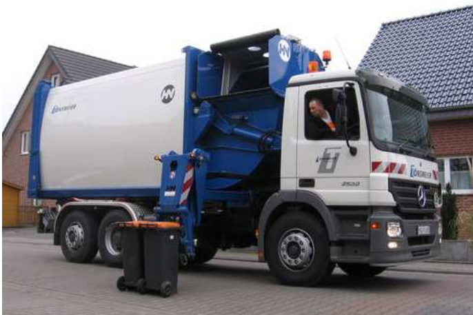
Ein Seitenlader-Fahrzeug nimmt max. 2 Mülltonnen mit einem hydraulischen Seitenarm auf.
