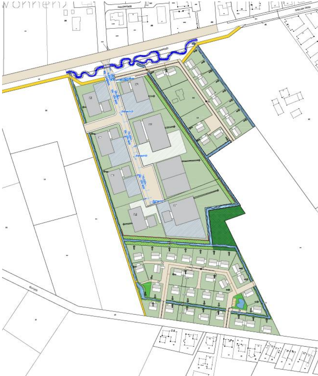
Abb. 2 Auszug aus dem Entwurf des Entwässerungskonzeptes zur Aufstellung des Bebauungsplans Nr. 62 „Rengeringsbruch I“ der Gemeinde Hövelhof (WELLING & PARTNER 2025).
